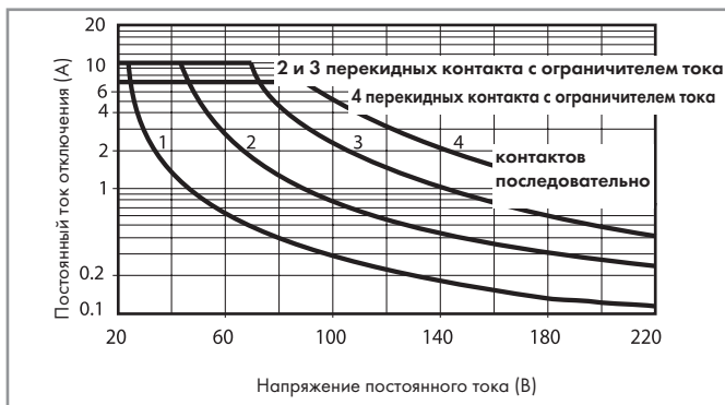
H 55 - Макс. отключающая способность DC1
